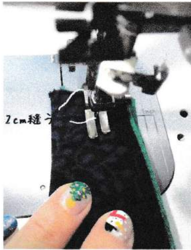
7、本体の両脇を表を見えるようにして しるしのところを縫います
